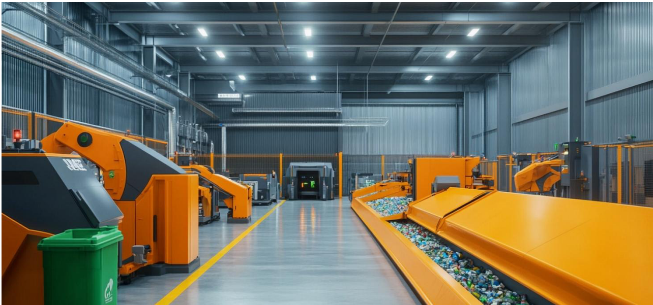
Automatisierte Sortieranlage mit Förderbändern zur Kunststofftrennung
